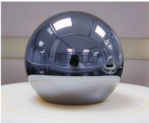
Fig. 3. Esfera de monocristal de silicio.
