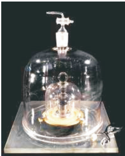
Fig. 1. Prototipo Internacional del kilogramo conservado en la Oficina Internacional de Pesas y Medidas ubicada en Sèvres Francia.
