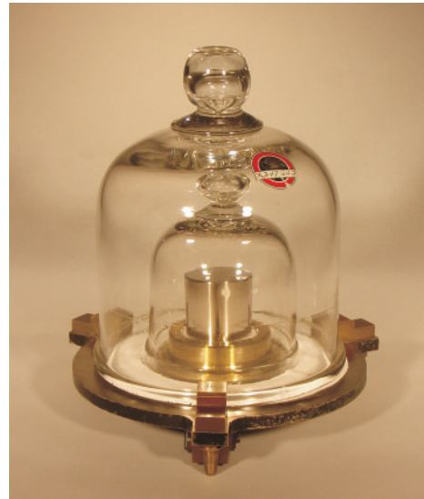
Fig. 4. Patrón Nacional de Masa de México, prototipo de platino iridio K21 conservado en el CENAM.
